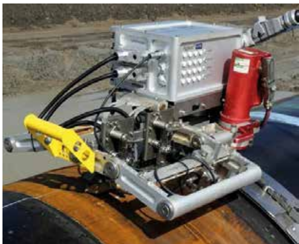
Figur 3: Felt utplassering av ett ultralydavbildningssystem (IWEX), hvorved sanntids bilder dannes under skanning
