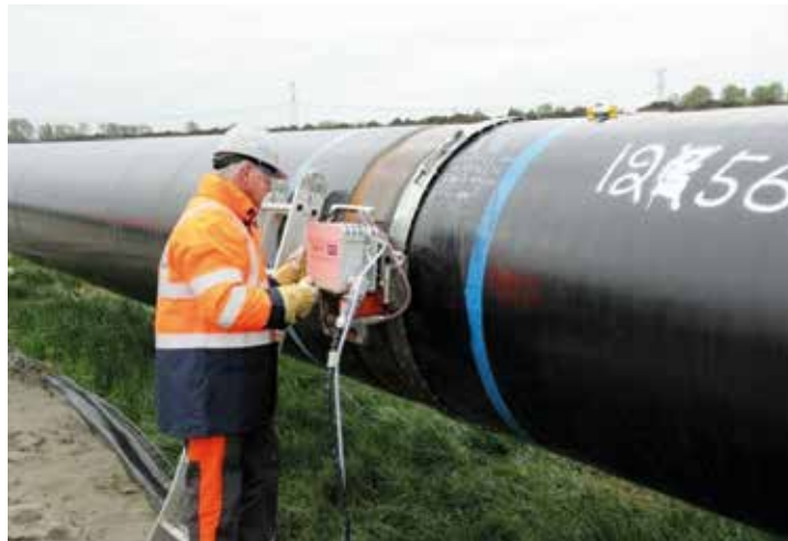
Figur 3: Felt utplassering av ett ultralydavbildningssystem (IWEX), hvorved sanntids bilder dannes under skanning
