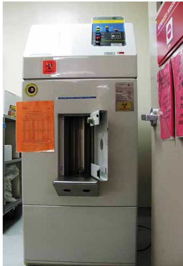
Figur 3: Blodbestråler, brukes for å sterilisere blod som skal gis til pasienter med svekket immunforsvar
